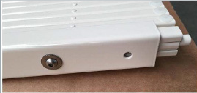
Oberer Drehzapfen, Rückenverstärkung montiert
